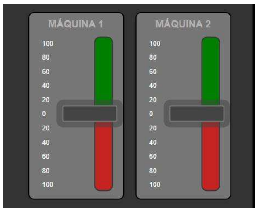
Fig. 31. Controles de mando de aceleración de motores. (a) Control de aceleración motor izquierdo, (b) Control de aceleración motor derecho.
