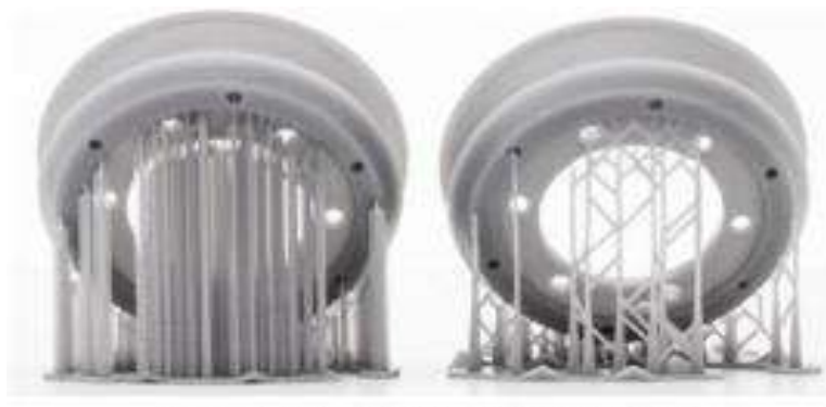
Figura 5. Representación de soportes en impresión 3D.
