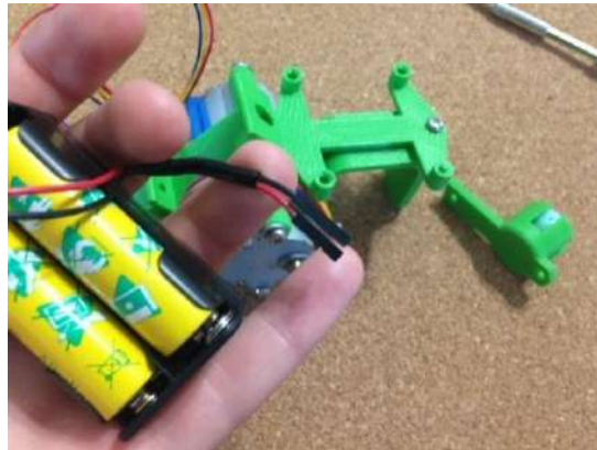
Figura 13. Montaje de baterías.
