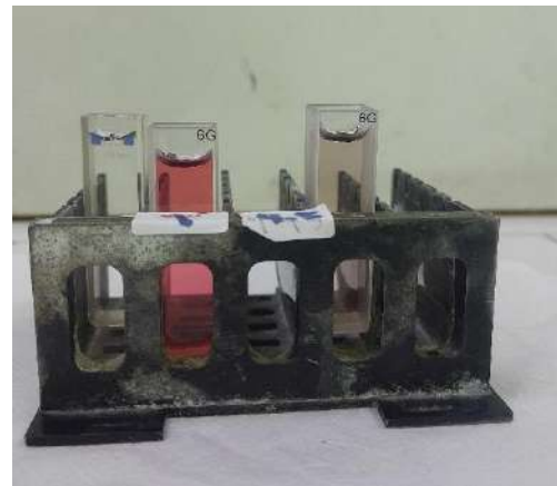
Identificación y cuantificación de antocianinas por espectrofotometría UV VIS
