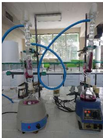
Figura 1. Equipos Soxhlet conectados en serie. [Elaboración propia]
