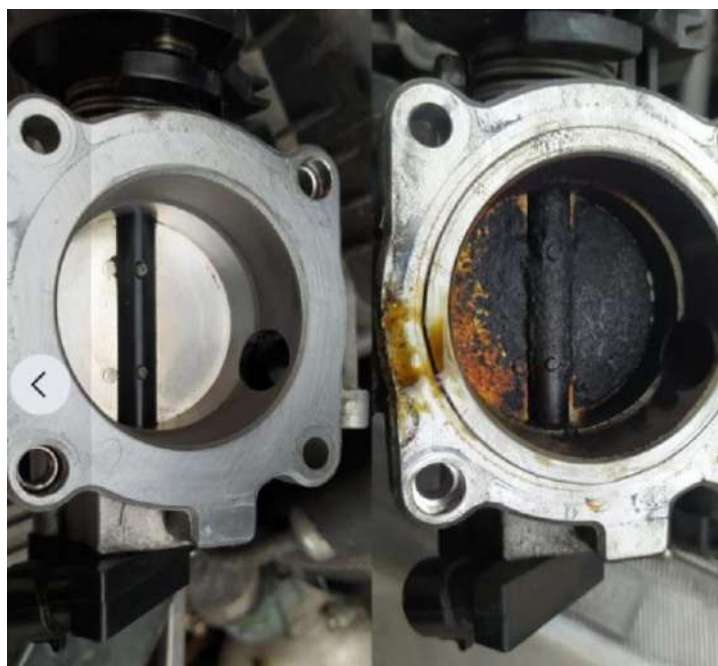
Fig. 4 Ejemplo de cuerpo de aceleración sucio.
