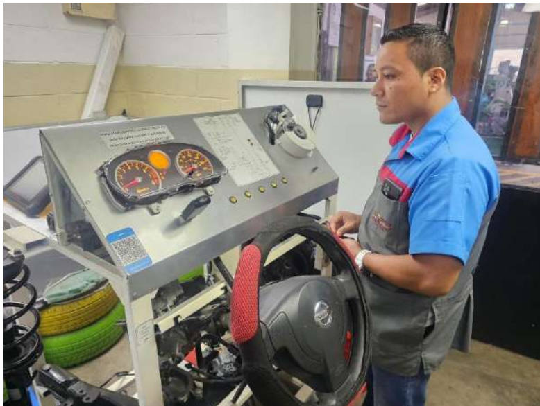
Prueba de enlace de datos entre selectora y TCM.
