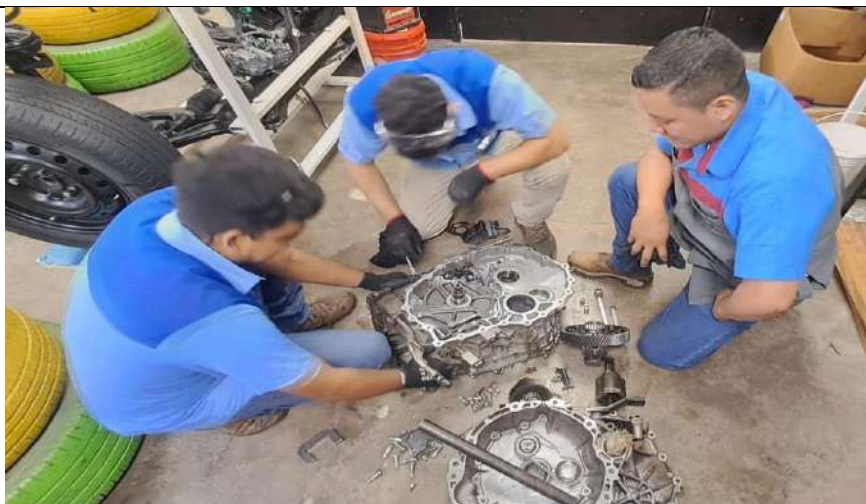
Desarmado de transmision para extraccion de cuerpo de valvulas.
