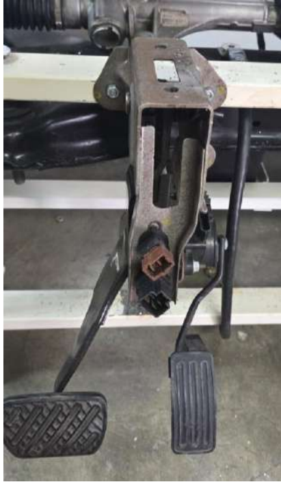
Pedal y cuerpo de aceleración instalado en estructura metálica.
