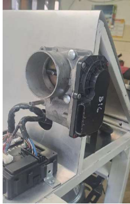
Pedal y cuerpo de aceleración instalado en estructura metálica.
