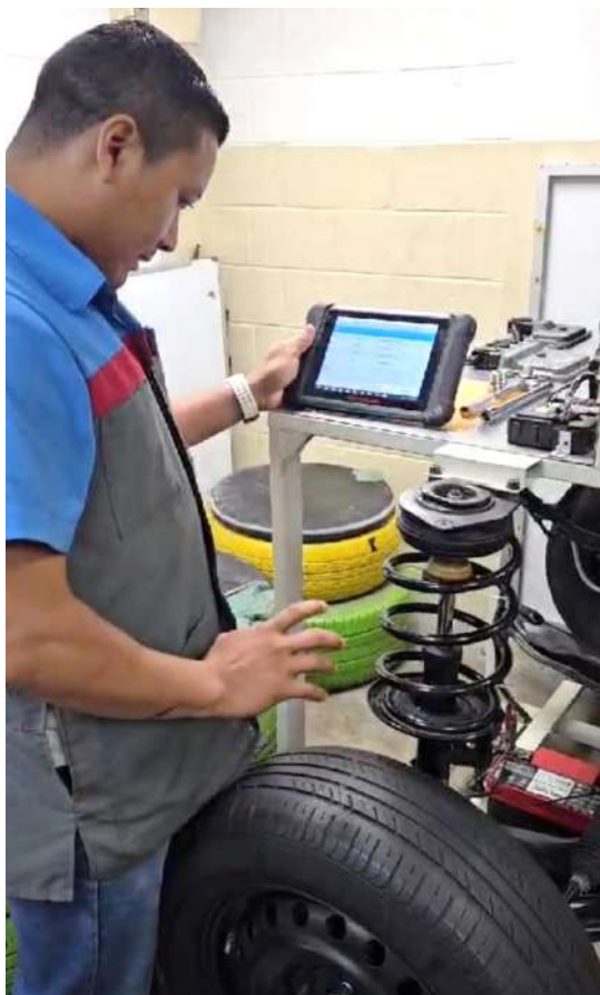
Comprobando comunicación del módulo de transmisión TCM.
