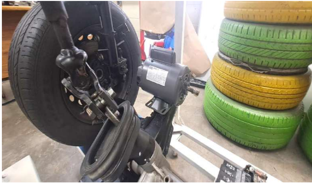
Ubicación del motor eléctrico.
