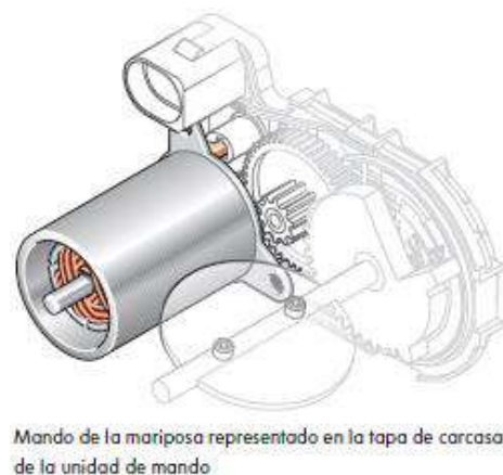
Fig. 11 Motor eléctrico, actuador del sistema.
