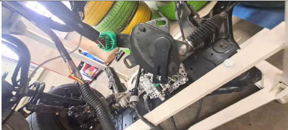
Prueba electrica de selectora de velocidades.
