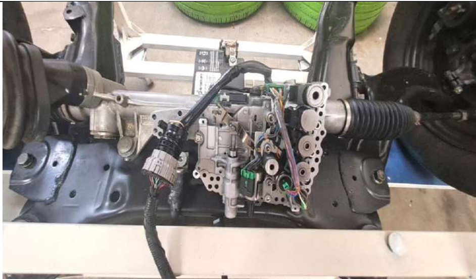
Prueba eléctrica de cuerpo de válvulas.
