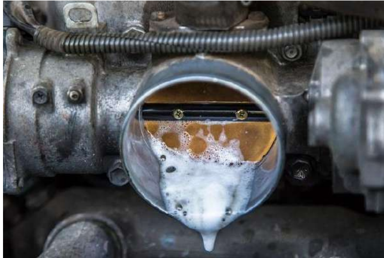
Fig. 5 Proceso de limpieza del cuerpo de aceleración.
