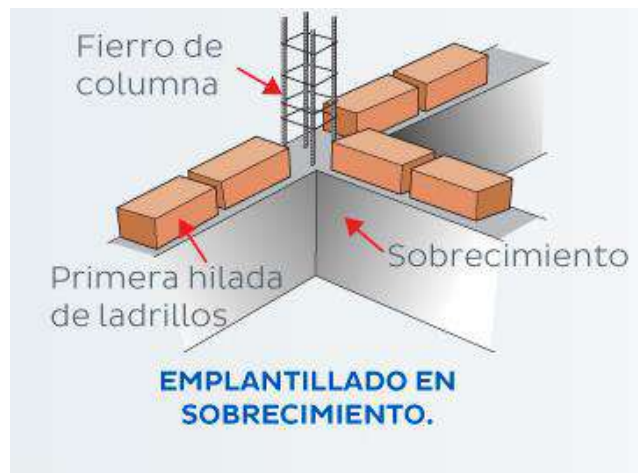
Figura 9. Emplantillado de ladrillo de arcilla sólido.
