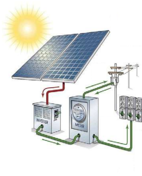
Fig. 2 - Sistema solar fotovoltaico inyectado a la red.
