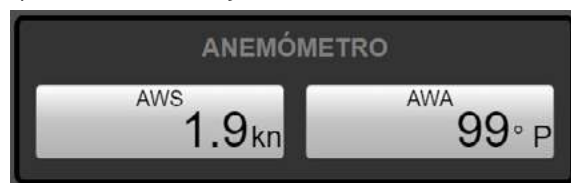
Fig. 6. Indicador Anemómetro, (a) Indicador de Velocidad de Viento Aparente, (b) Indicador de Ángulo de Viento Aparente.
