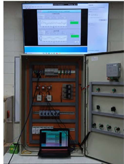
Fig. 7: Panel de Control Automático y pantalla LabVIEW.
