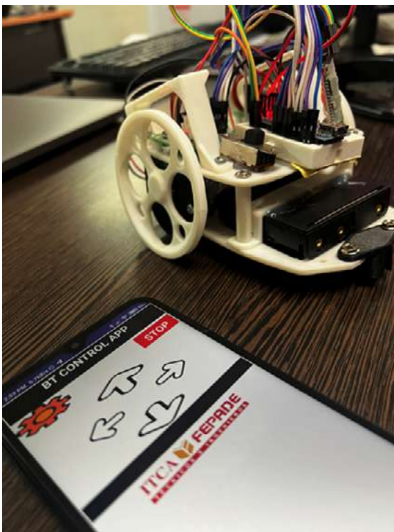
Fig. 2. Manipulación del robot con la App de control remoto.
