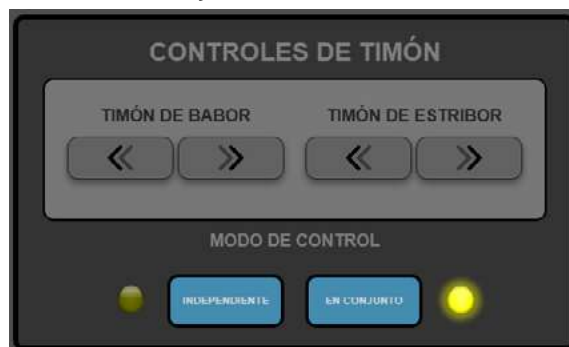
Fig. 8. Controles de Timón. Timón de Babor, Timón de Estribor, Modo de Control.
