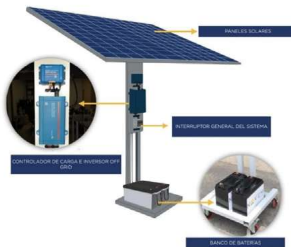
Fig. 1 Sistema solar fotovoltaico aislado.
