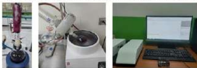
Figura 2. Obtención de extracto de flor de Jamaica por lixiviación y rotoevaporación. Espectrofotómetro UV VIS. [Elaboración propia]
