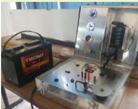
Equipo para el diagnóstico de dispositivos electrónicos usados en el encendido de motores de combustión interna.
