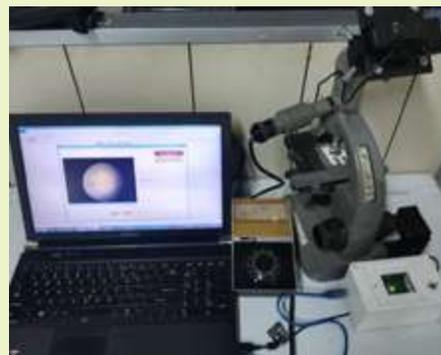
Dispositivo electromecánico para convertir un microscopio metalográfico convencional en microscopio metalográfico digital.
