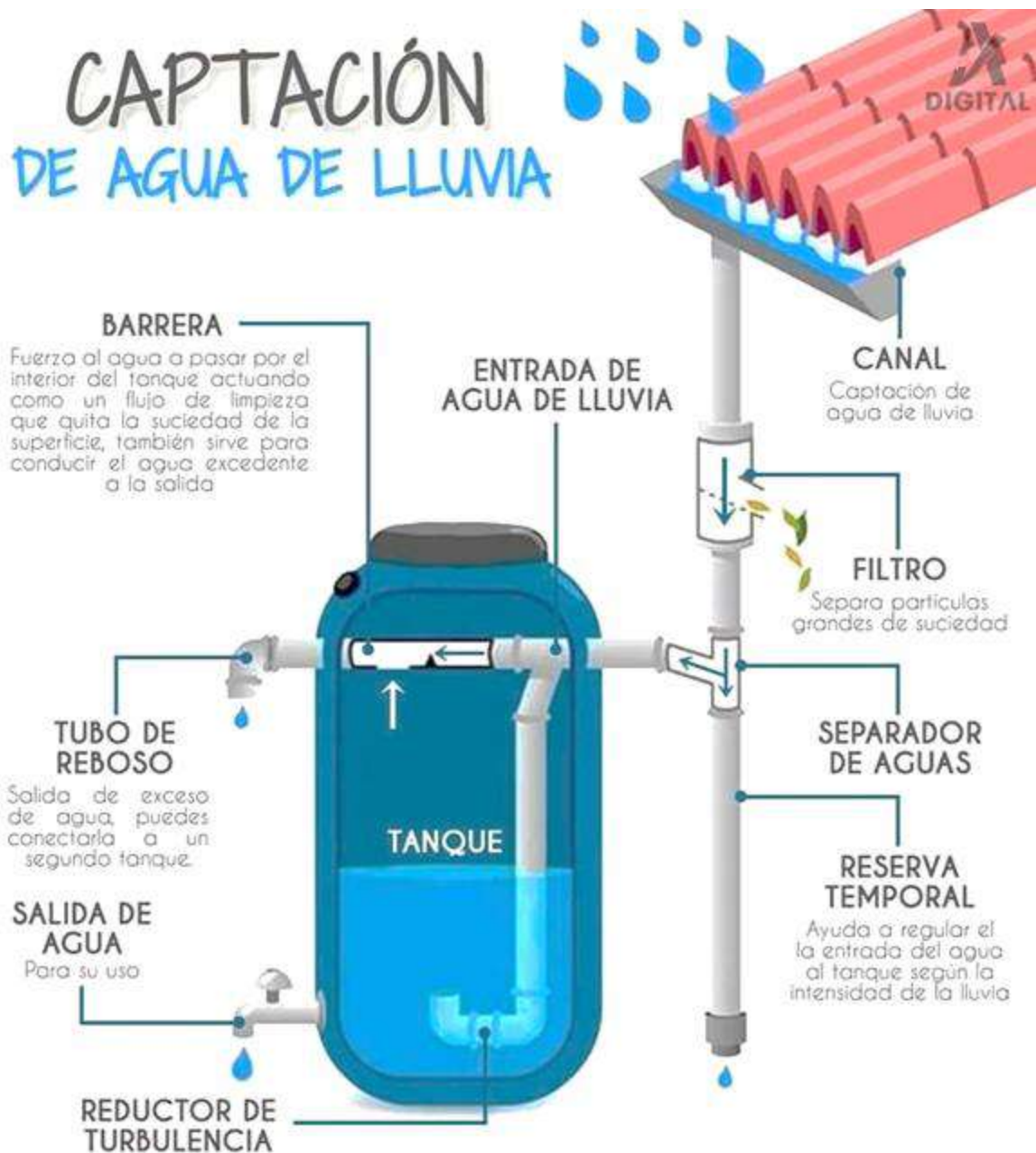
Imagen 10. Sistema de captación de aguas lluvias.
