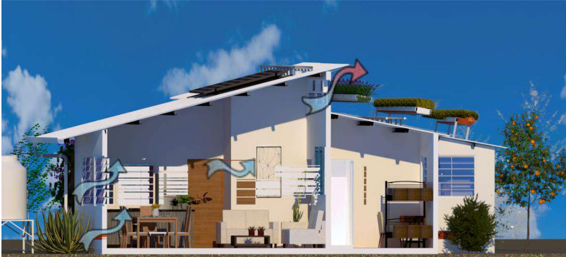
Imagen 49. Ventilación natural asistida por efecto chimenea.
