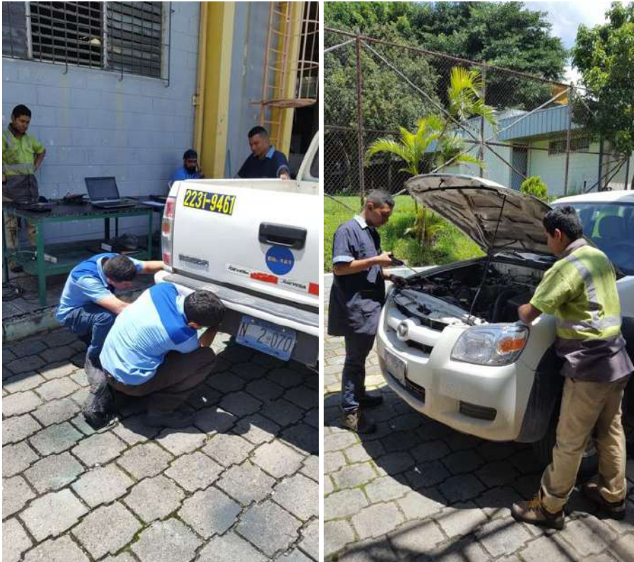
Docentes y estudiantes de la carrera de Técnico en Ingeniería Automotriz trabajando en la medición de gases del parque vehicular de la PGR.
