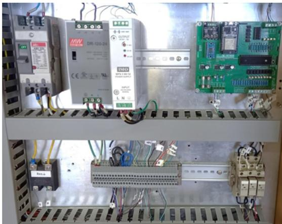
Fig. 7. Conexiones de control y potencia en el entrenador. En la esquina superior derecha puede observarse el circuito controlador electrónico diseñado.
