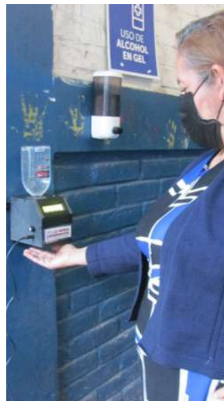
Instalación de estación integrada y automática para toma y alerta audible de temperatura y dosificación de alcohol en centros escolares.
