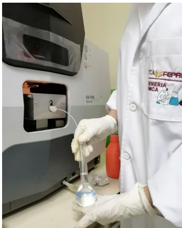
Figura 10. Medición de estándar de potasio en Espectrofotómetro de Absorción Atómica (EAA).
