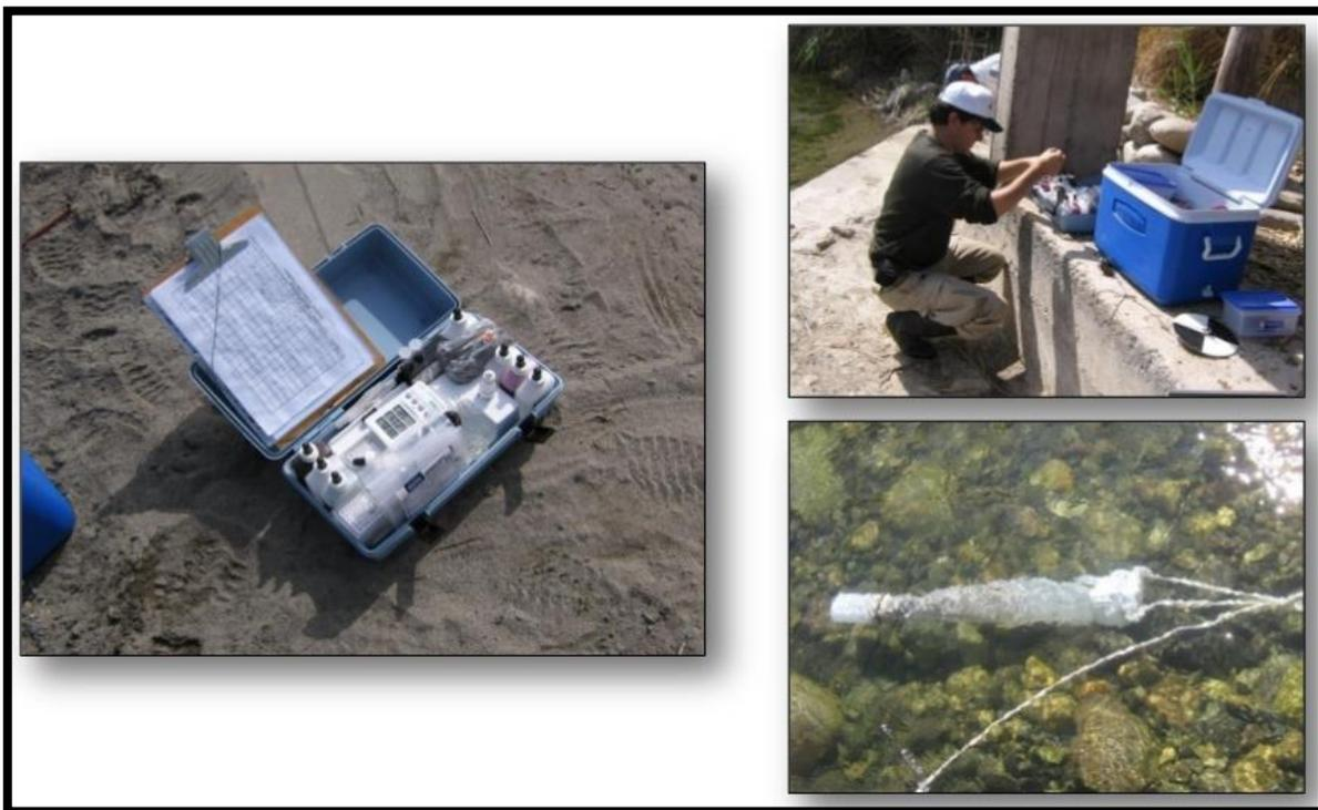
**Fotografía 9: Toma de parámetros físico químico para determinar la calidad del agua de los estanques**
