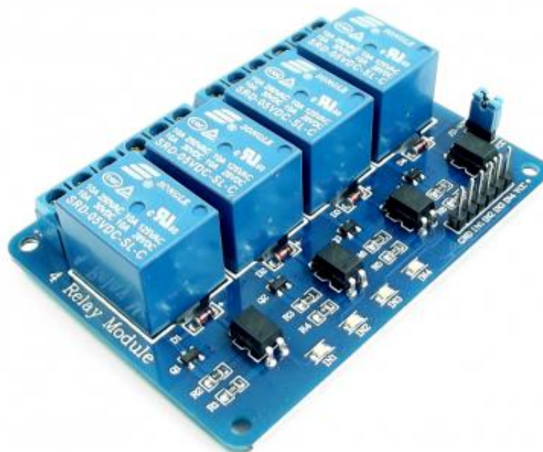
Fig. 6. Módulo de relés 5 voltios.
