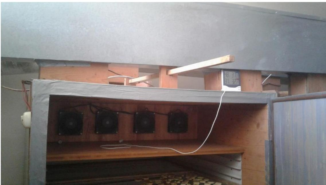
Fig. 32 Distribución interna de aire en los hornos de deshidratado.
