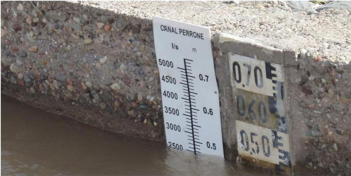
Fig. 6 Sensor por inmersión, utilizando regla telemétrica.
