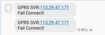
Ese mensaje es enviado cuando la señal de cobertura es demasiado débil para sincronizar la RTU con la web, sin embargo tiene la suficiente fuerza para enviar mensajes de texto, significa que aunque no se sincronice en ese instante con la web, tiene la capacidad de notificar cualquier incremento en el nivel del Río.
