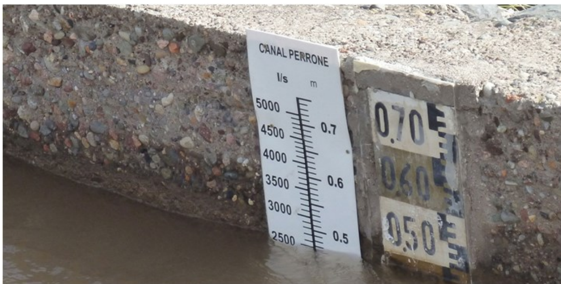
Foto 1: Sensor por inmersión, utilizando regla telemétrica.
