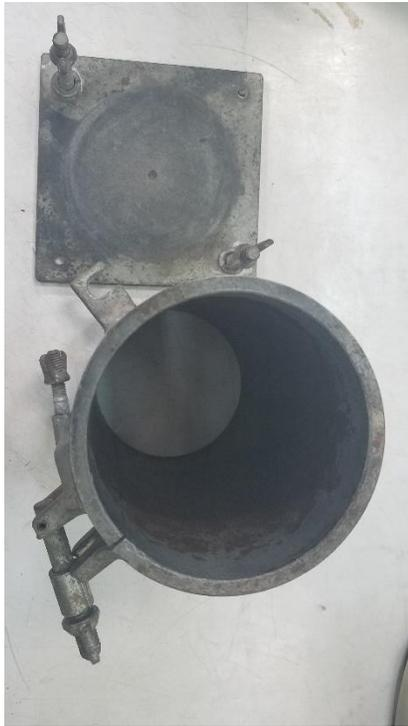
**Figura 30.** Molde utilizado para fundir el plástico.
