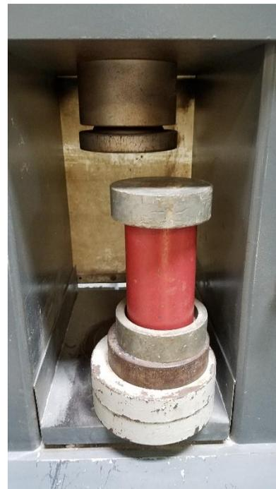
**Figura 37.** La máquina de compresión registra la carga aplicada a la probeta, en el caso del plástico polietileno, la probeta no sufrió rupturas, solo una deformación en vertical y horizontal.
