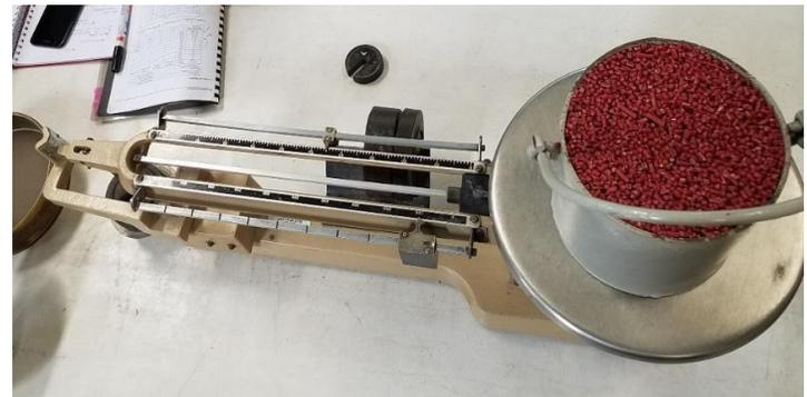
**Figura 25.** Luego se vuelve a pesar el molde más el material dentro.
