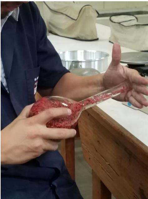
**Figura 28.** Se procede a desairar el picnómetro.
