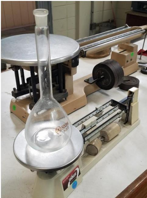
**Figura 26.** Se pesa el picnómetro seco y vacío.
