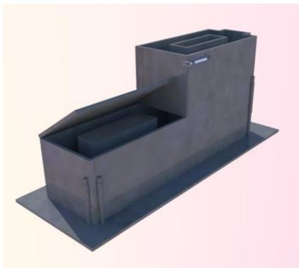
**Figura 40.** Modelo 3D de molde metálico para fundir plástico.
