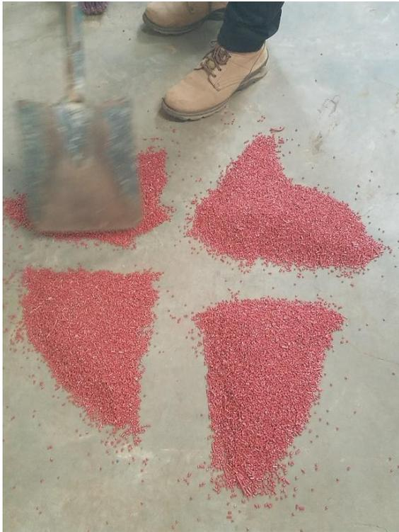
**Figura 17.** Cuarteo de material a analizar.
