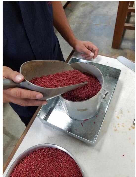
**Figura 23.** Colocación de material plástico al molde.
