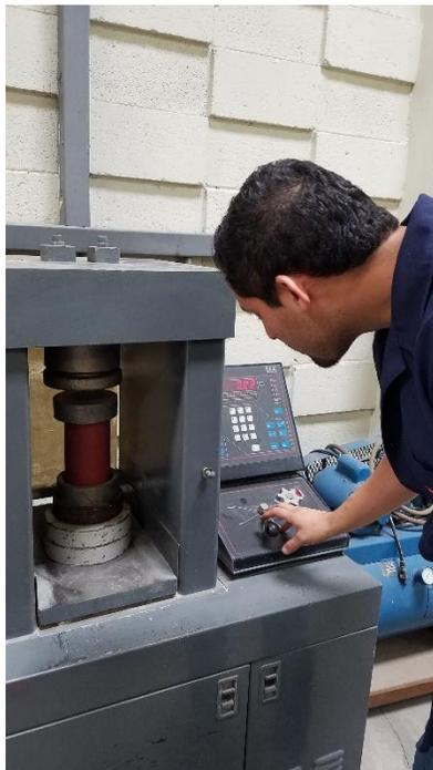
**Figura 36.** La probeta obtenida de plástico, se coloca en la máquina de compresión para aplicarle la carga con una carga y velocidad continua.
