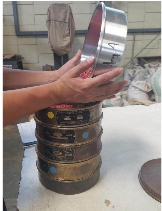
**Figura 18.** Colocación de material en tamices.
