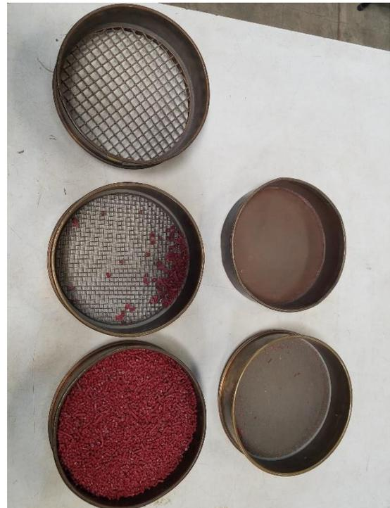
**Figura 20.** Material retenido en las diferentes mallas.
