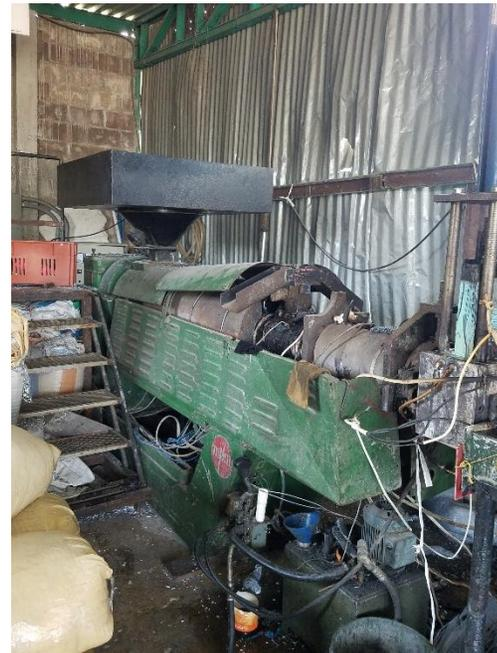
**Figura 11 y 12.** Cuando se ha secado el material, se lleva a la fase en la que se vierte en una tolva el plástico picado y luego va pasando por un tornillo sin fin en una maquina extrusora, a una alta temperatura que logra fundir el plástico.
