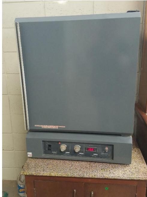
1. Aquí es donde se introduce el molde lleno de plástico peletizado al horno. El plástico debe alcanzar una temperatura de  $180^{\circ}$ , para transformarse de sólido a líquido.
