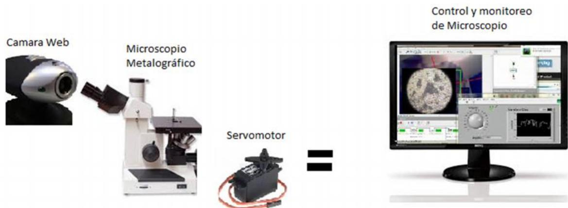
*Ilustración 24. Interacción de elementos*
