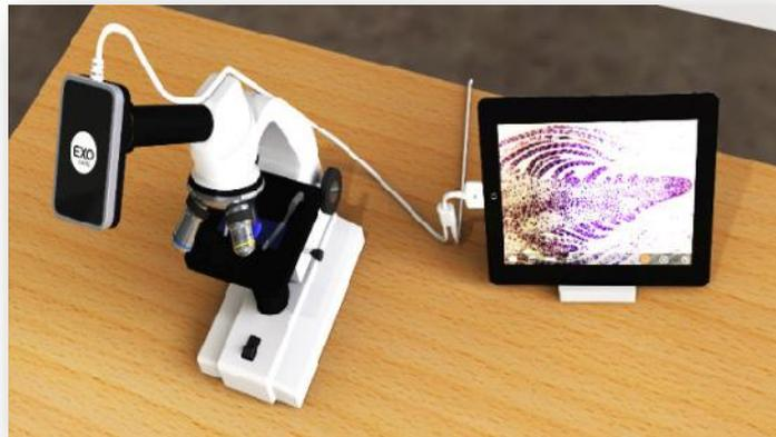
*Ilustración 1. Adaptación de cámara en microscopio con salida de imagen a un monitor*
