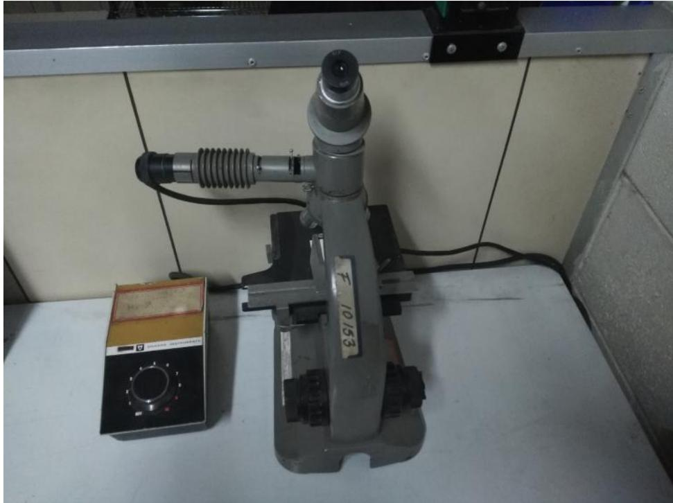
Ilustración 33. Microscopio metalográfico convencional
