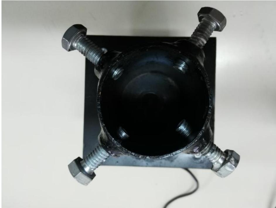
Ilustración 31. Vista de planta de accesorio para adaptar cámara digital al microscopio
