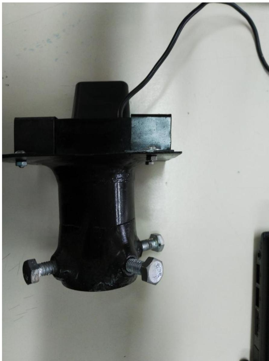
Ilustración 30. Accesorio para adaptar cámara digital al microscopio
