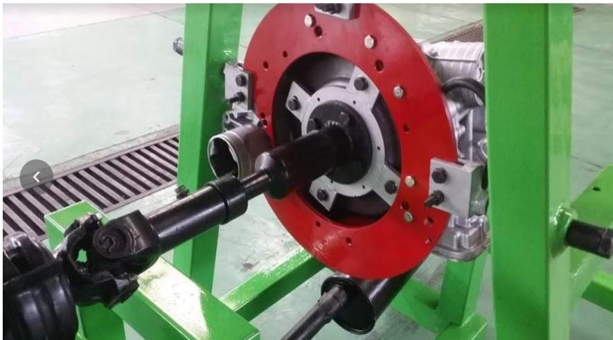
Paso 4 Se monta la transmisión al banco de prueba, teniendo el cuidado de que el convertidor de par acople adecuadamente, se debe sujetar la transmisión considerando las precauciones del paso 2.
