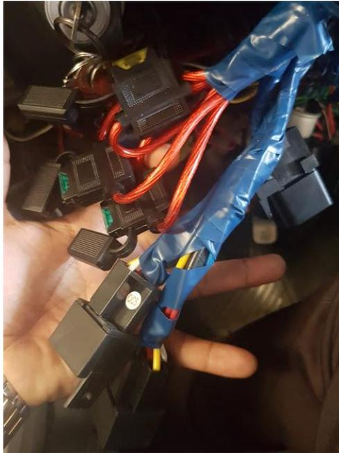
Figura 2.1 Restauración del ramal eléctrico de control
