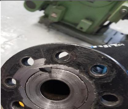
Fabricación de cuñero y soldadura de pieza.
