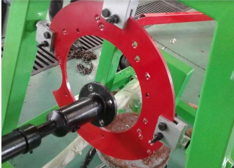
Paso 3 Se procede a conectar el convertidor de par de la transmisión al banco de prueba. Se debe tener el cuidado de que todos los pernos se encuentren adecuadamente colocados y apretados.
