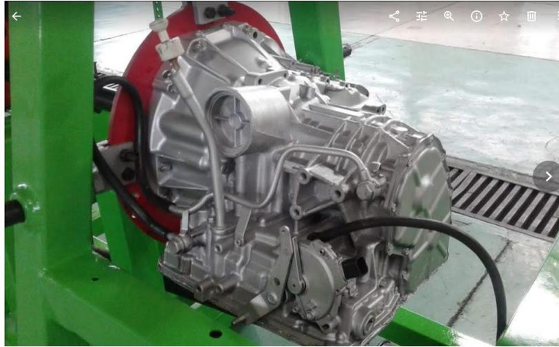
Paso 5 Se Instalan los sensores de presión a las puertos de medición de presión mostrados en la siguiente figura.
