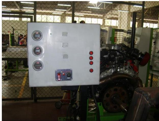
Fig.14 Tablero de control instalado en el banco de prueba
