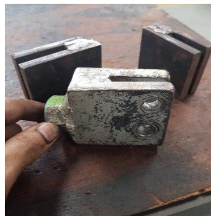
**Maquinado de pieza metálicas de soporte de transmisión automática**
