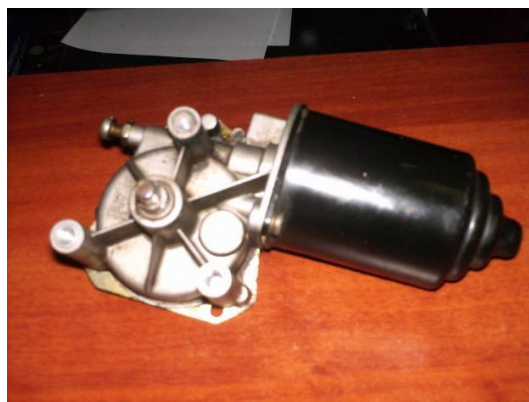
Fig. 5: Motores DC a 12 V, 80 W
