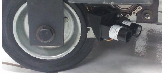
Fig. 22: Sensor LIDAR con Servomecanismo Fig. 23: Sensor LIDAR instalado a un costado del AGV
