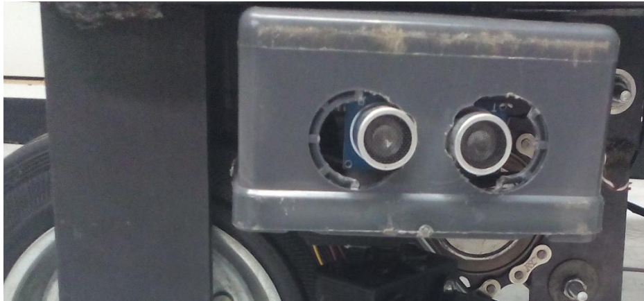
Fig. 29: Sensor ultrasónico montado en AGV
