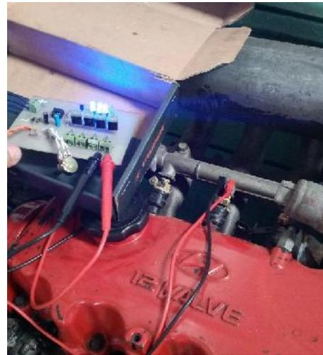
Prueba de inyectores gasolina
