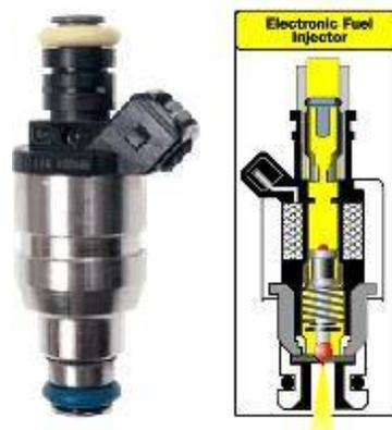
Fig. 11 Estructura física y esquema interno del inyector de gasolina.
