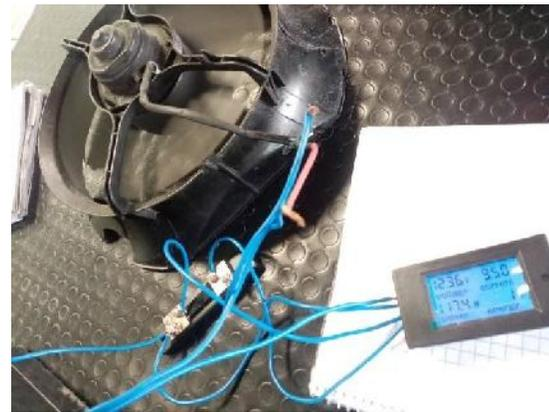
Prueba de consumo de amperaje de ventilador 12V
