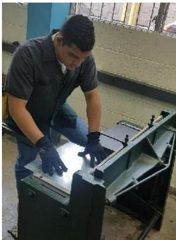
Proceso de corte y doblado de lámina.
