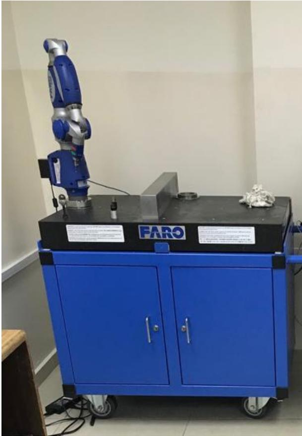
**Fig. 10.** Brazo de medición 3D FARO Gage.
