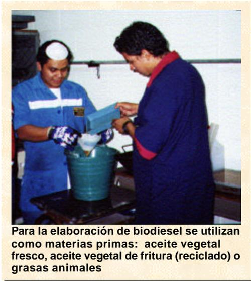
El biodiesel, es un combustible líquido no contaminante y biodegradable, que puede ser usado para el transporte público, agrícola y marino, así como para calderas en la industria. Las materias primas para producirlo pueden ser: aceite vegetal fresco, aceite vegetal de fritura (reciclado) o grasas animales. Para la producción de biodiesel durante la investigación se utilizó aceite vegetal de fritura, proveniente de la Cafetería Escuela del ITCA, además de Metanol y Sosa Cáustica como reactivos.
