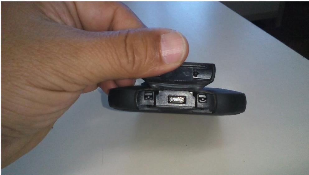
Fig. 28. Puerto USB micro-B de cámara FLIR C2.
