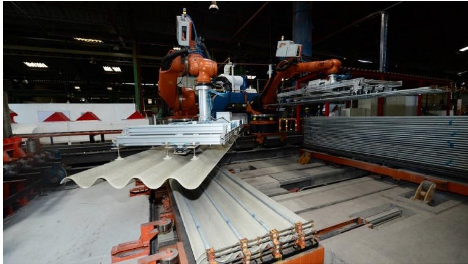
Ilustración 1: Robot industrial instalado en Industria de fibrocemento.
