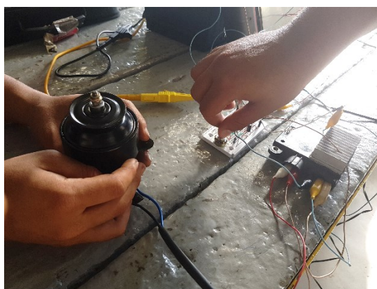
Prueba de circuito variador de velocidad.
