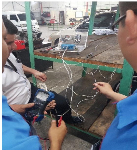
Realización de pruebas en componentes a utilizar para circuito calentador de bobinas.
