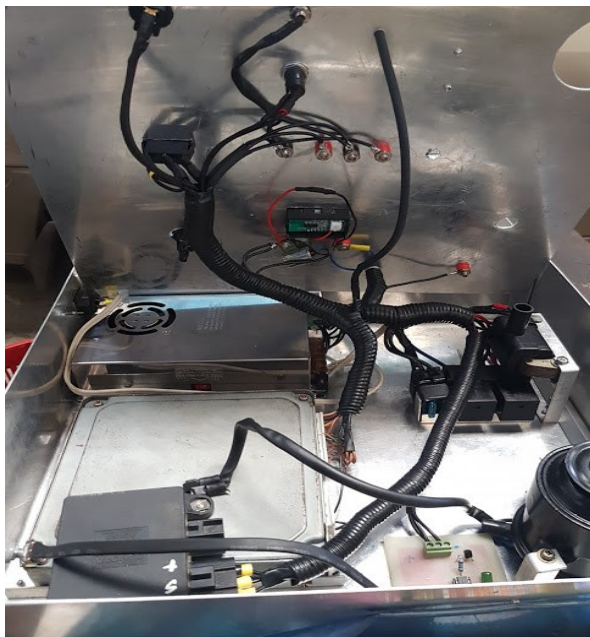
Aislamiento de cable eléctrico de componentes.
