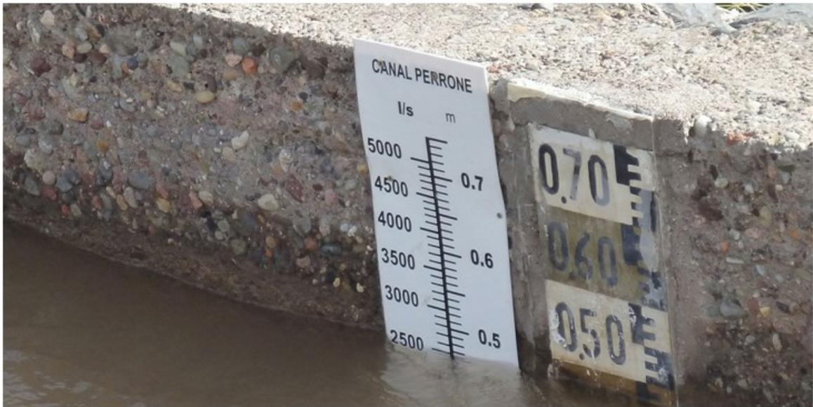
Foto 1: Sensor por inmersión, utilizando regla telemétrica.
