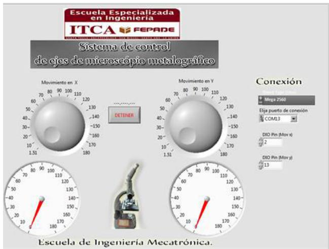
Ilustración 5. Software controlador de servo motores
