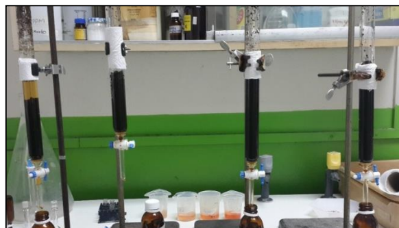
Filtrado de agua con metales pesados para verificar el funcionamiento de la bio-resina.
