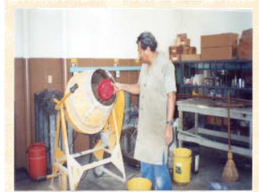
Proceso de preparación de la mezcla experimental a partir de cartón, tierra blanca y cemento, para la fabricación de los ladrillos
