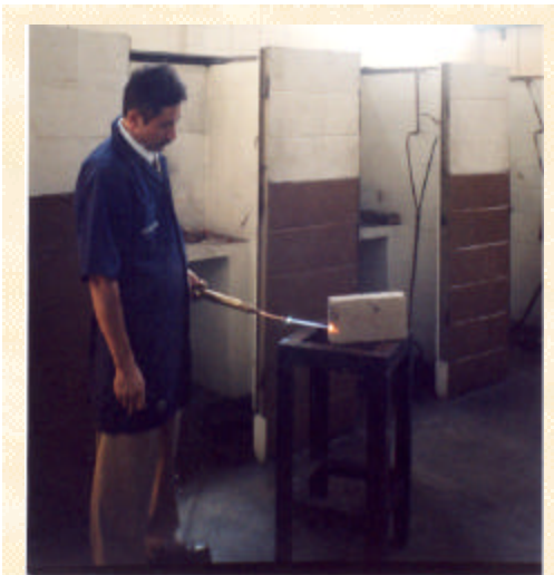
Realización de la prueba de la llama en los ladrillos fabricados con mezcla experimental
