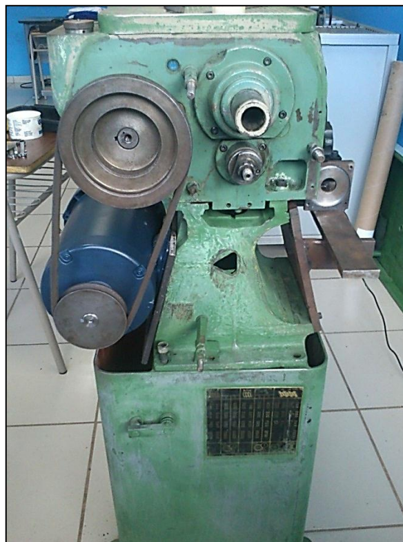
Montaje de motor AC y servos.
