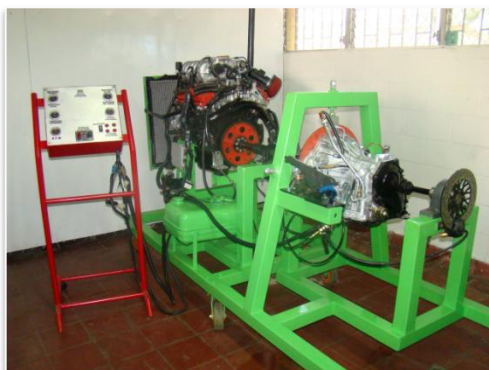
Figura 3. Banco con motor de combustión interna V6 (seis cilindros en V).
