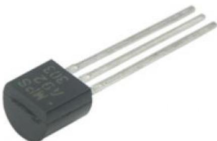
Fig. 24. Forma física de un Transistor BJT
