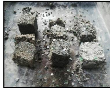
*Foto 12, 13 y 14. Resultado de la Prueba de Compresión. Proceso realizado en el taller de Ingeniería Civil y Arquitectura.*
