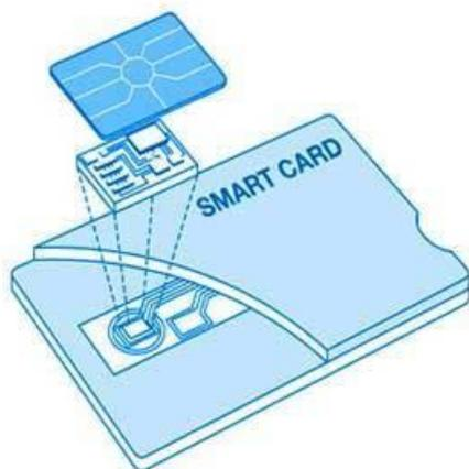
**Fig. 1. Composición de una tarjeta inteligente con contactos.**
