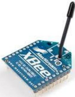
**Fig. 21. Forma física del Xbee shield**
