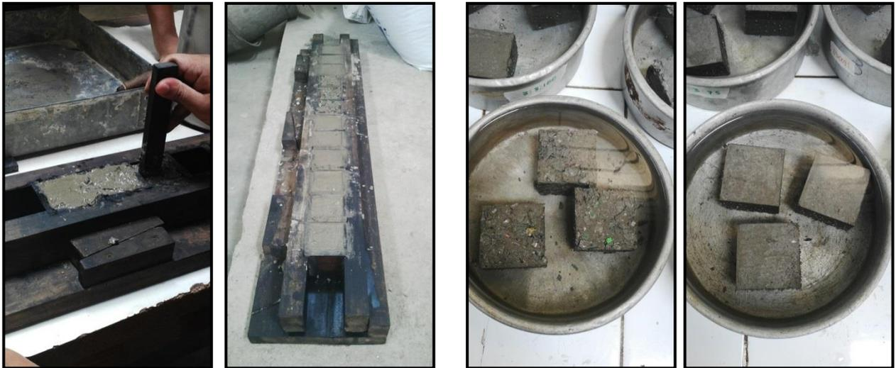
Foto 5 y 6. Llenado de Moldes. Proceso realizado en el taller de Ingeniería Civil y Arquitectura ITCA – FEPADE; Sede Central
