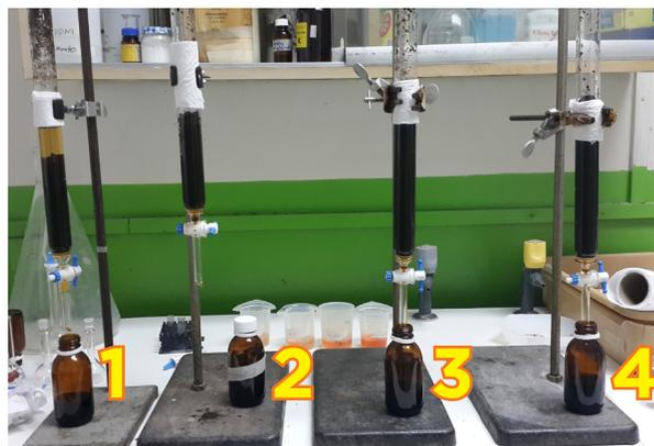
Fig. 3. Filtros elaborados con la bio-resina. [Elaboración propia]
