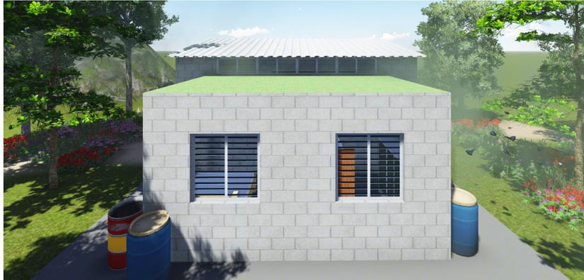
Fig. 3. Perspectiva de vivienda bioclimática, fachada posterior, ubicación de losa verde sobre habitaciones
