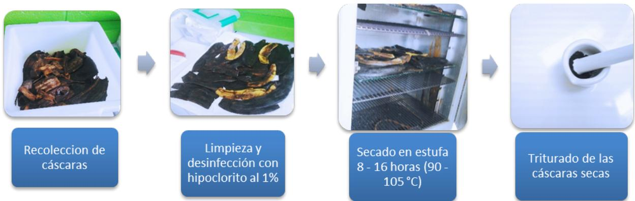
Fig. 1. Recolección, secado y triturado de las cáscaras de guineo y plátano. [Elaboración propia]
