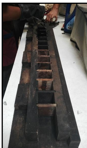
Foto 1 y 2. Preparación de Moldes.
